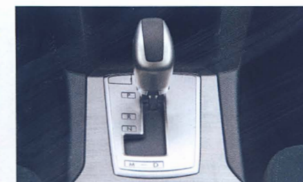
Prevodovka Lineartronic radí veľmi dobre, k dispozícii je aj manuálne radenie predvolených šiestich stupňov (aj páčkami na volante).
