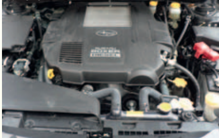
Naftový motor typu boxer zaručuje nízke ťažisko
